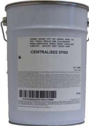
Graisse molle à base de savon calcium et d'huiles de base synthétiques de façon à assurer une bonne lubrification sans se raffermir trop aux basses températures. Elle est particulièrement destinée à la lubrification par système centralisé basse ou moyenne pression (20 à 60 bars). Il s'agit d'une graisse fluide formulée pour offrir d'excellentes propriétés d'écoulement à toutes les températures.
